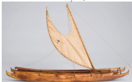
Pour le marin polynésien, il s'agit en effet de maîtriser l'écoulement du vent relatif sur une surface dont on contrôle au mieux la forme dans l'espace, et non pas de se contenter de tendre une toile en travers du vent réel comme le faisaient de façon élémentaire les utilisateurs de voiles carrées.
