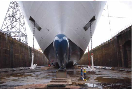
Les formes et la rugosité de la carène sont des facteurs primordiaux influant sur le rendement hydrodynamique du navire : carène *Poesia* avec silicone.
