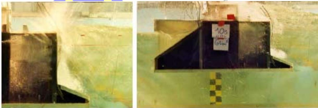
Fig. 11 : Houle centennale sur la contre-jetée : essais pour le projet de l'extension de Monaco, réalisés au laboratoire Océanide de la Seine sur Mer
