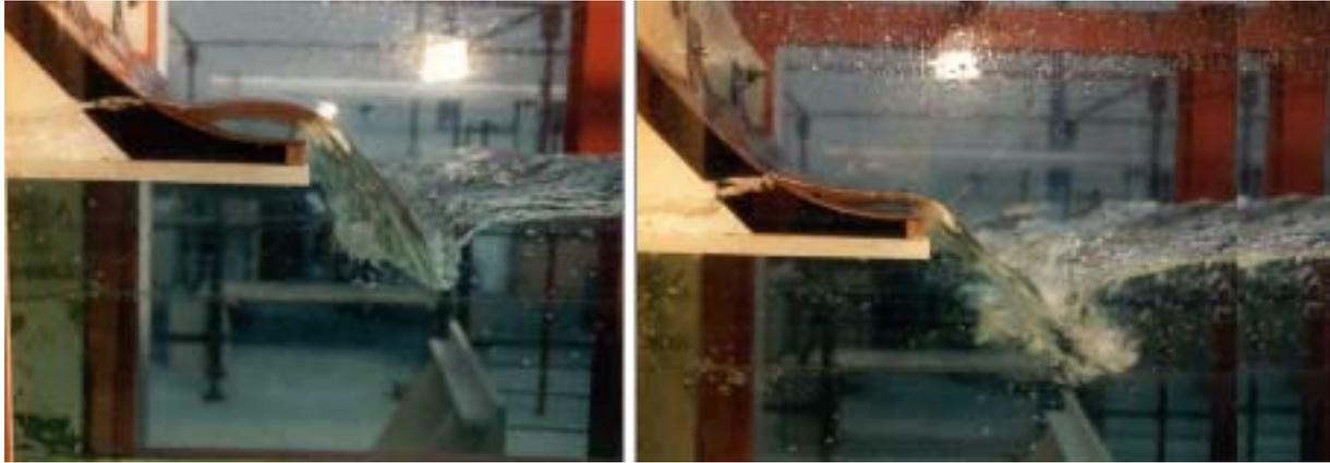
Fig.10 : Béquet avant du BYBOP Essais réalisés au laboratoire de Géomorphologie de Caen.
