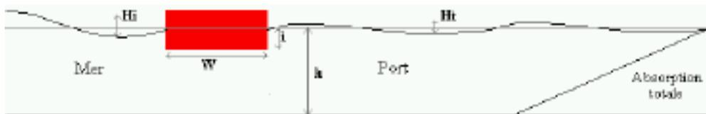
Fig. 4 : Système « Mur d'Eau Fixe ».
